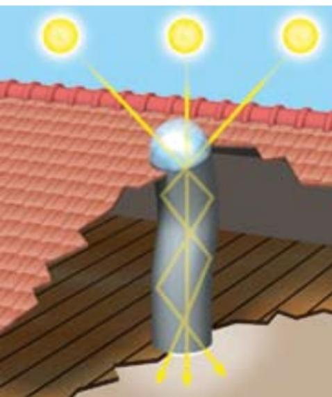
*Des pièces sans fenêtre profitent de l'éclairage naturel avec la mise en place de « puits de lumière » ou de « conduits solaires » : un collecteur situé sur le toit distribue la lumière dans un conduit réfléchissant qui éclaire une pièce aveugle.*
